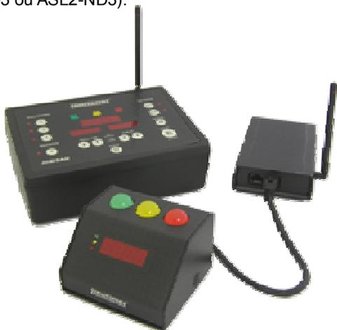
Remarque : il n'est pas possible d'utiliser le Limitimer PRO-2000RF à proximité de signaux lumineux DSAN, car les deux produits émettent sur la même fréquence.
