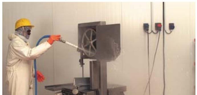
→ **Essai pré lavage dégraissage** : essai conduit avec un appareil haute pression réglé entre 70 et 90 bars. Eau chaude comprise entre 70 et 80 °C. Pulvérisation à 50 cm pendant une minute sans application directe sur le produit testé.
