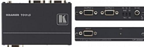
Le VP-200K est un distributeur amplificateur pour les signaux informatiques graphiques de résolution jusqu'à UXGA et plus. Le produit accepte une entrée, réalise l'isolation et l'amplification et distribue le signal sur deux sorties identiques.
