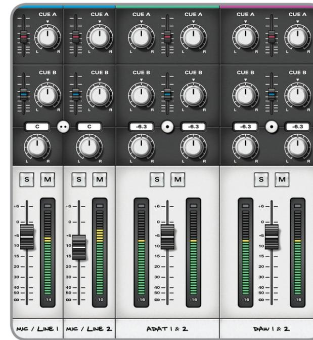
Les canaux d'entrée **analogiques** sont tirés directement des deux convertisseurs A/N (retours d'insert). Les signaux disponibles ici sont : microphone, ligne, D.I (canal 2) ou entrée ligne à gain unitaire par la prise de retour.
