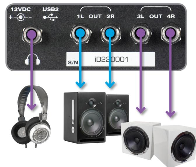
Les quatre sorties ligne sont symétrisées électroniquement par la même topologie que dans notre célèbre console, l'ASP8024.
