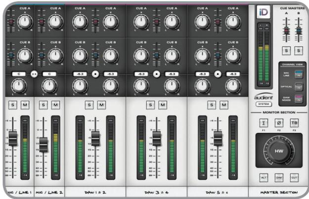
Pour une écoute de contrôle/lecture simple ou un mixage en interne, il peut être plus ergonomique de n'afficher que la section master.
